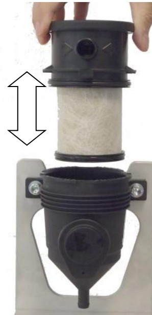
Bild 11 Wechsel Ölabscheider ProVent 150
