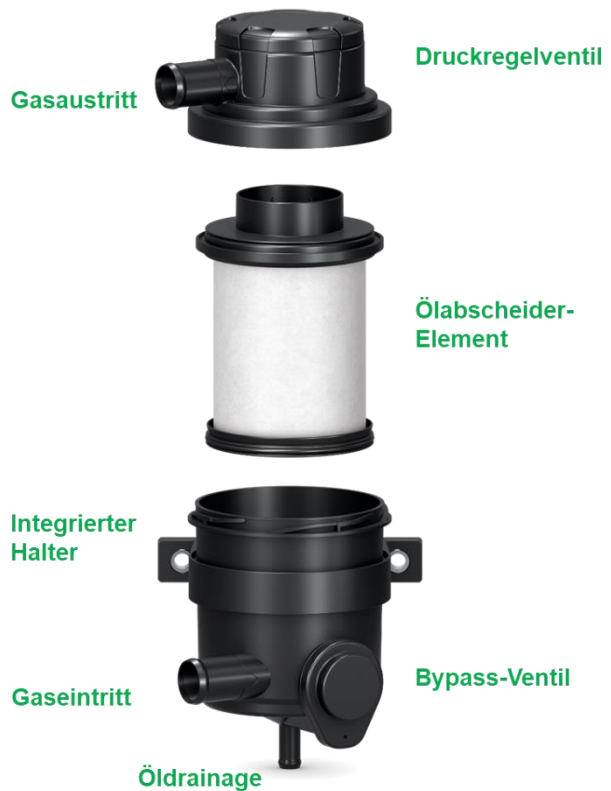
Abb. 2: Aufbau ProVent² 200
