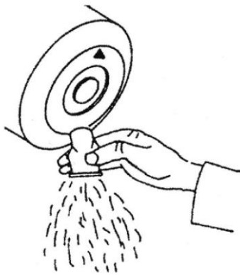
Fig. 9 Limpiar la válvula de extracción de polvo
