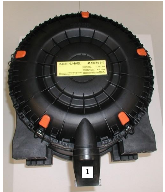
Fig. 10 Vanne d'évacuation des poussières
