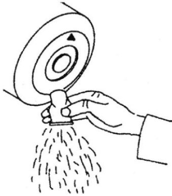
Fig. 9 Nettoyage de la vanne d'évacuation des poussières
