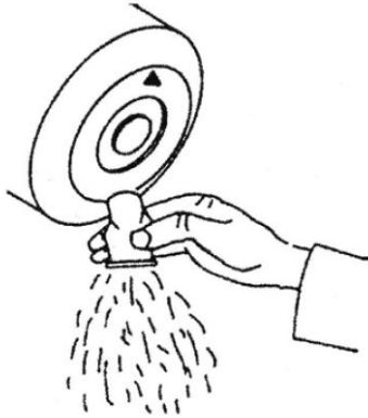
Fig. 9 Pulire la valvola di scarico polvere
