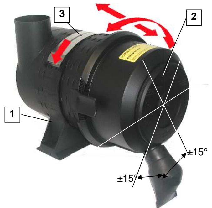
Bild 2 Einbauwinkel Staubaustragsventil
