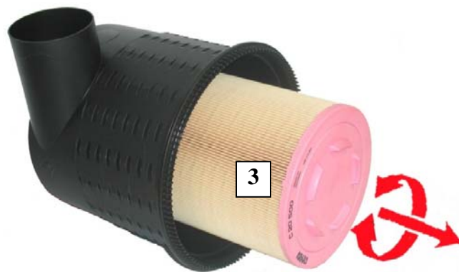
Obr. 5 Vyjmutí hlavního filtračního prvku
