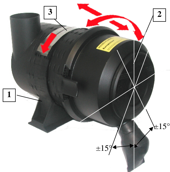
Obr. 2 Úhel montáže ventilu k vynášení prachu
