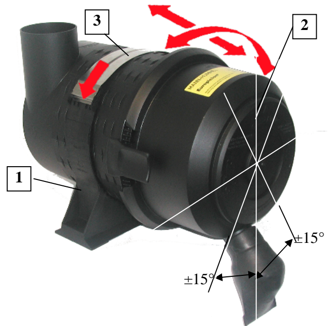
Fig. 2 Ángulo de montaje de la válvula extractora de polvo
