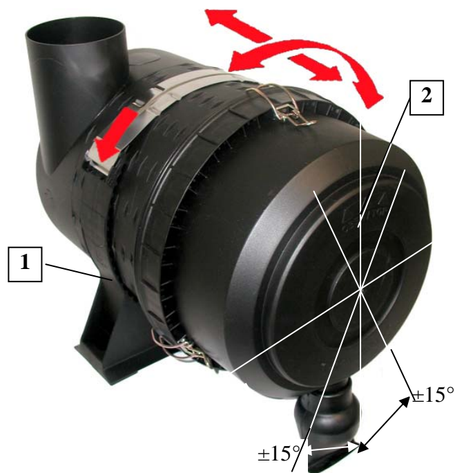
Рис. 2 Угол установки клапана удаления пыли
