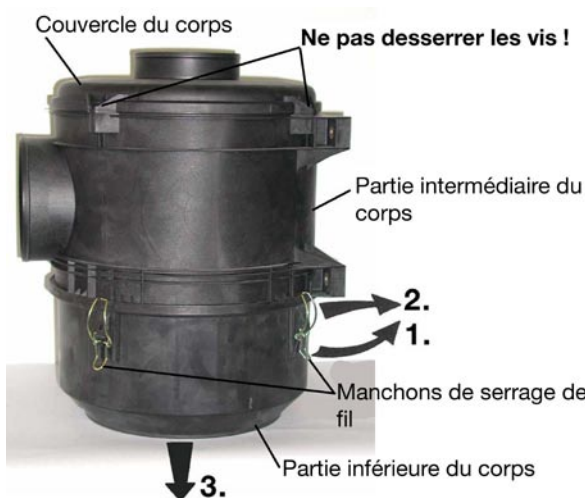
Fig. 1 : Enlèvement de la partie inférieure du corps
