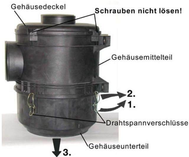
Bild 1: Gehäuseunterteil abnehmen
