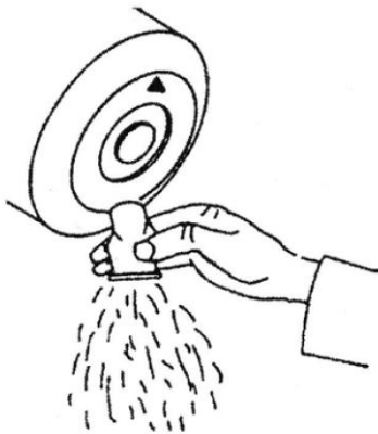
Fig. 7 Nettoyage de la vanne d'évacuation des poussières
