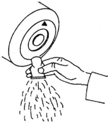
Fig. 7 Pulire la valvola di scarico polvere
