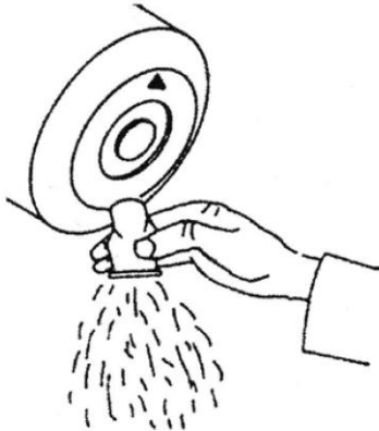
Fig. 7 Limpiar la válvula de extracción de polvo
