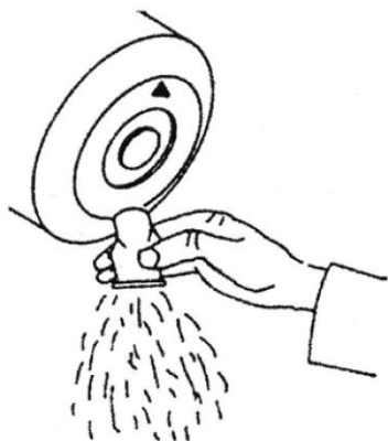
Obr. 7 Čištění ventilu k vynášení prachu
